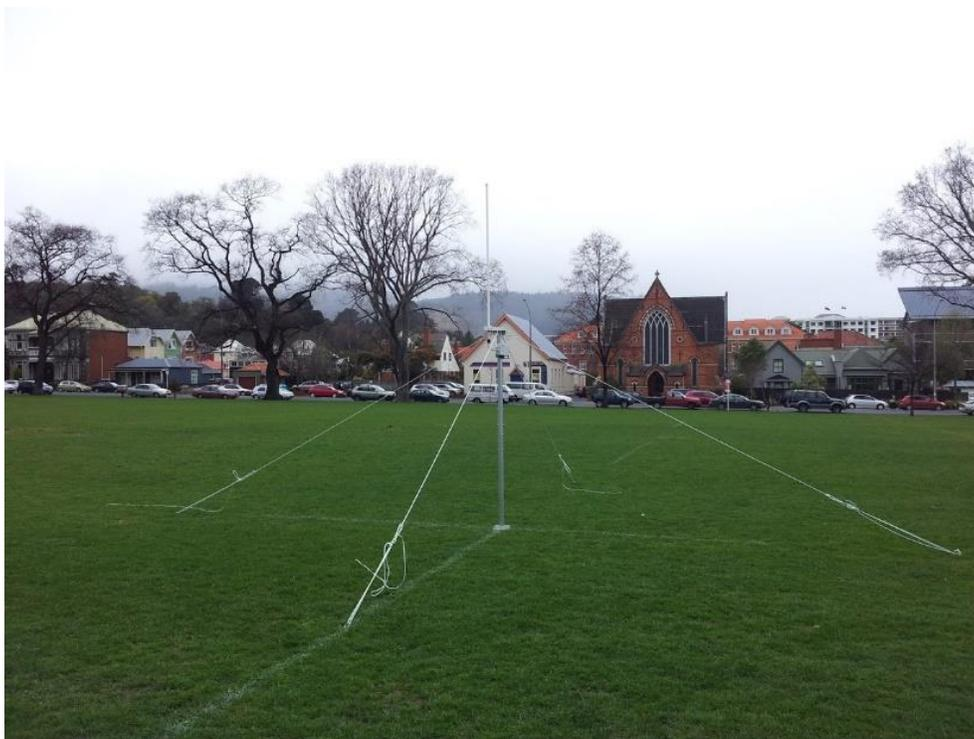
Ilustración 4.3 Antena tipo del método WWLLN<sup>19</sup>
